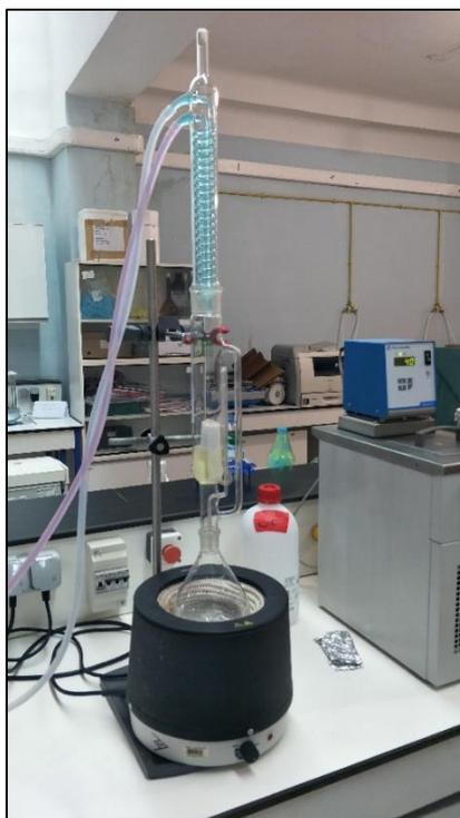
**Figure 48** : Montage Soxhlet.
