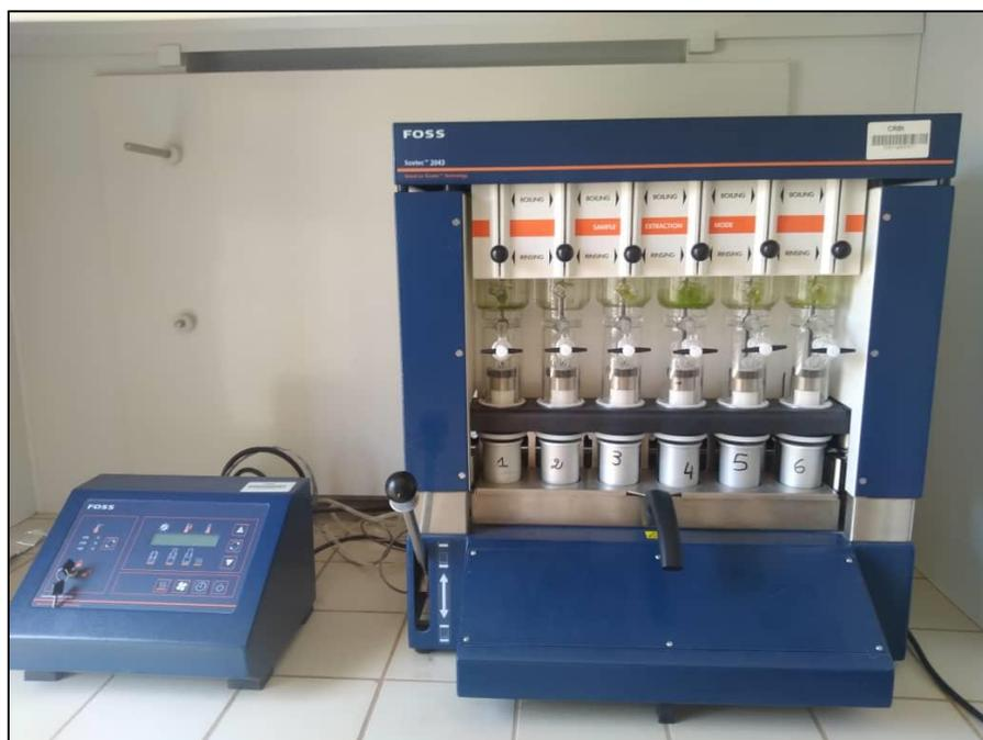
**Figure 50** : Extraction de la matière grasse à l'aide d'un appareil à système Soxhlet semi-automatique.
